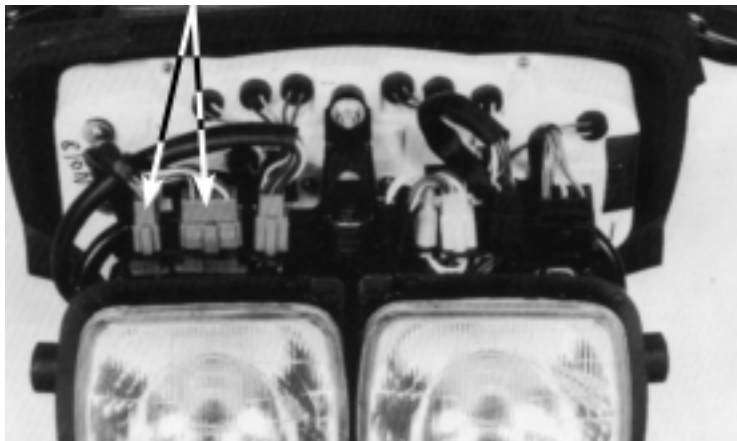
CONECTORES DA CAIXA DE FUSÍVEIS
