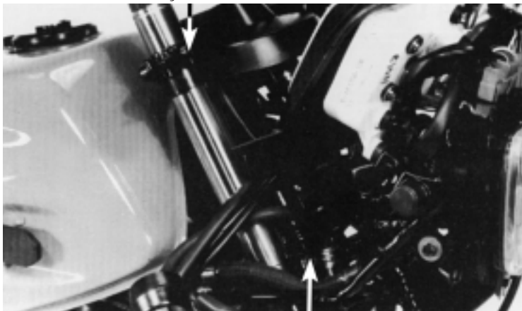
PARAFUSO DE FIXAÇÃO INFERIOR
