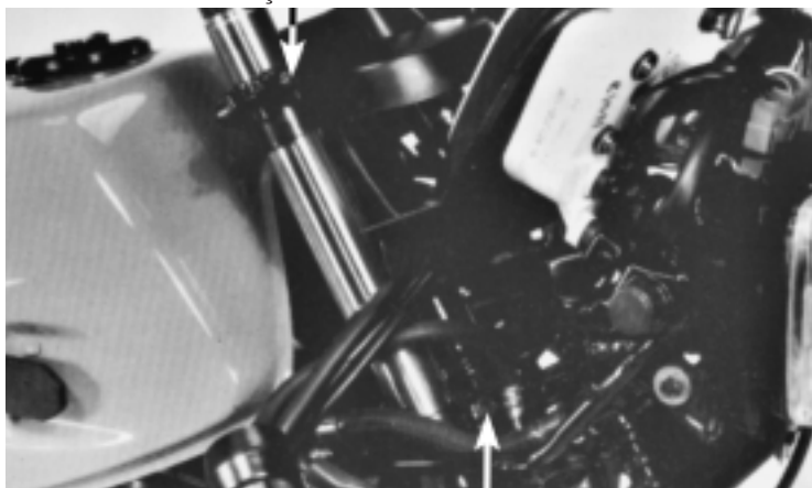
PARAFUSO DE FIXAÇÃO INFERIOR
