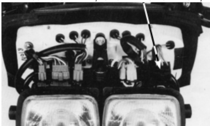
CONECTOR DA FIAÇÃO DO INTERRUPTOR DE IGNIÇÃO
